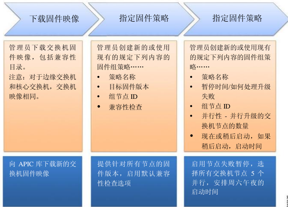
图 30：交换机固件升级过程
